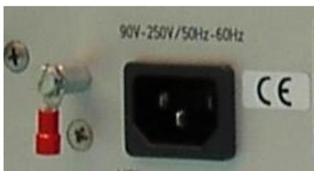
Erdungsanschluss und Netzanschluss
