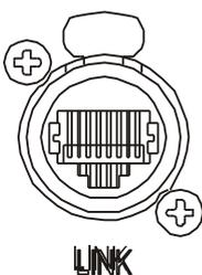
Anschlussbuchse VAN-LINK (RJ45) für die Kaskadierung (Audio) mit einem weiteren Kompaktsender MSI8V.
