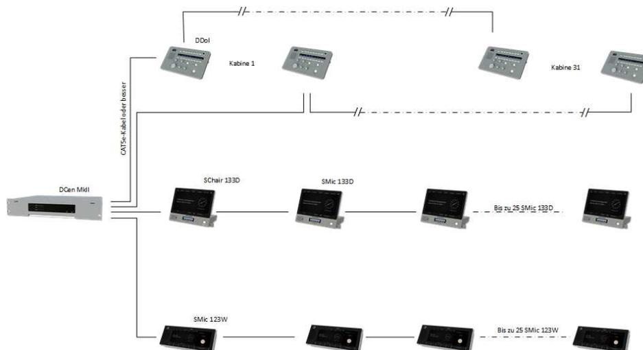
Verbinden Sie die SMic-Einheiten mit Ihrer Zentraleinheit – das System ist anschließend direkt einsatzbereit.
