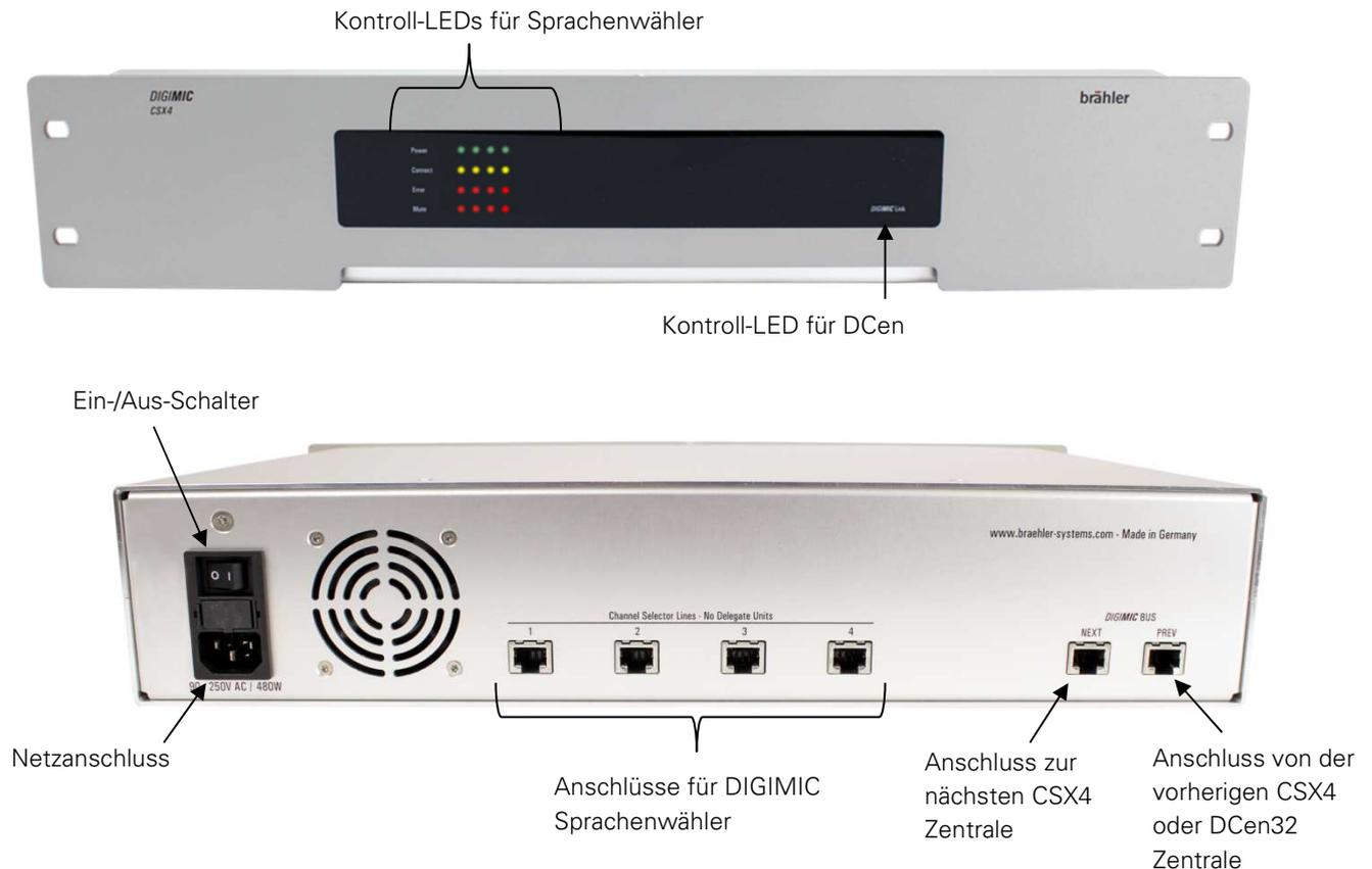
Die Zentraleinheit CSX4 wird mittels CAT5e-Kabel (oder besser) und RJ45-Steckern mit einer DCen32 und den Sprachenwähler-Einheiten verbunden.
