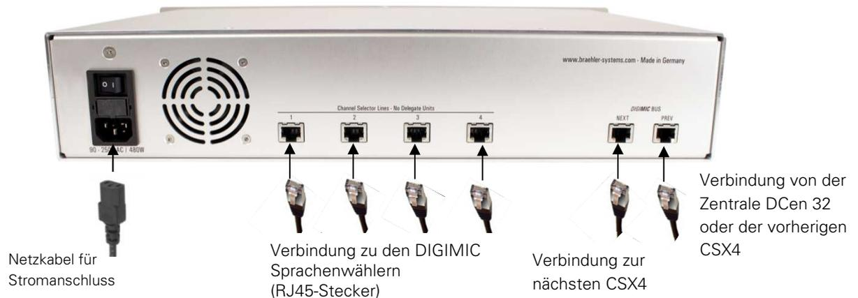
Verwenden Sie nur geeignete Kabel und Stecker. Um die CSX4 einzuschalten, betätigen Sie den Ein-/Ausschalter. Die CSX4 ist sofort einsatzbereit und kann über die DCEn32 gesteuert werden (manuell und per Computer).
