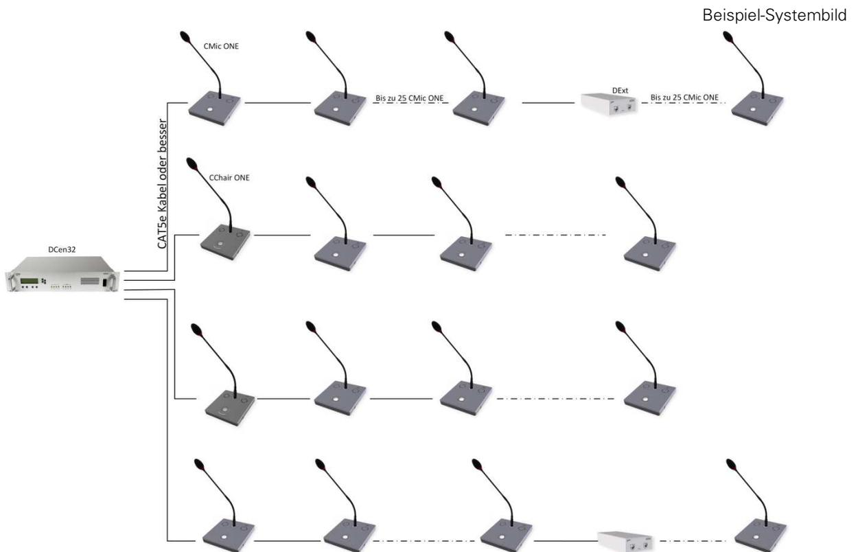
Die CMic ONE-Einheiten werden untereinander mittels CAT5e-Kabel oder besser verbunden. Durch das Zusatznetzteil DExt können CMic ONE-Ketten verlängert werden.
