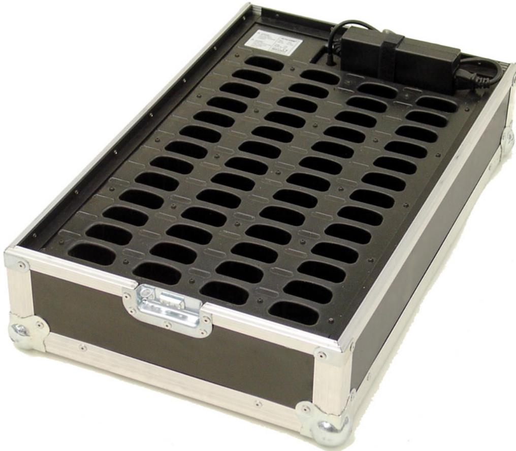
Die Transport- und Ladekassette TK50 ist für Aufbewahrung bzw. Transport sowie das Laden von je 50 INFRACOM® Empfängern IRX gedacht.
